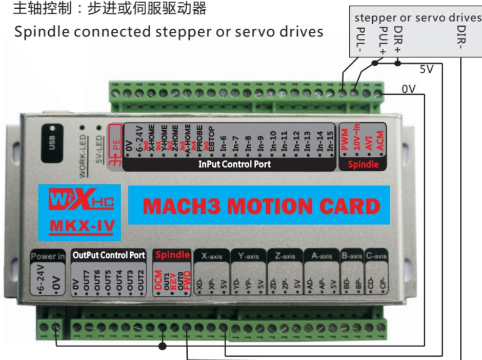
5.第5步：16个输入口IN0-IN15接法：限位开关等接口：输入低电平有效
